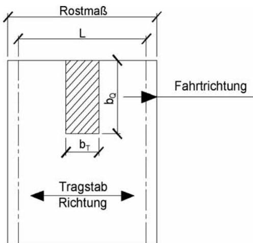
Bild 2 Schweißpressroste (Lastanordnung 2)
