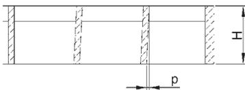
Schrägstellung der Trag- und Randstäbe  $p$  max. =  $0,1 \cdot H$ , jedoch max. 3 mm
