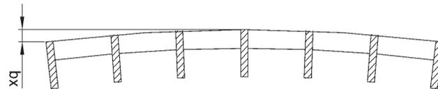
Abweichung für konvex  $x_q$  max. =  $\frac{1}{200}$  der Breite bei Abmessungen > 600 mm: max. 8 mm; kleinere Abmessungen als 600 mm: max. 3 mm
