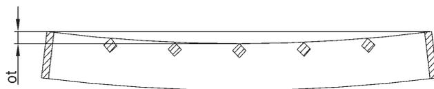
Abweichung für konkav  $ot \text{ max.} = \frac{1}{200}$  der Länge bei Abmessungen  $> 600 \text{ mm}$ : max. 8 mm; kleinere Abmessungen als 600 mm: max. 3 mm
