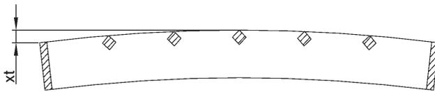
Abweichung für konvex  $xt \text{ max.} = \frac{1}{150}$  der Länge bei Abmessungen  $> 450 \text{ mm}$ : max. 8 mm; kleinere Abmessungen als 450 mm: max. 3 mm
