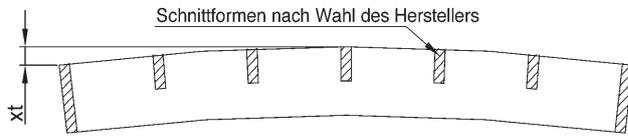
Abweichung für konvex  $x_t$  max. =  $\frac{1}{200}$  der Länge bei Abmessungen > 600 mm: max. 8 mm; kleinere Abmessungen als 600 mm: max. 3 mm
