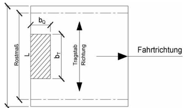
Bild 1 – Schweißpressroste (Lastordnung 1)
