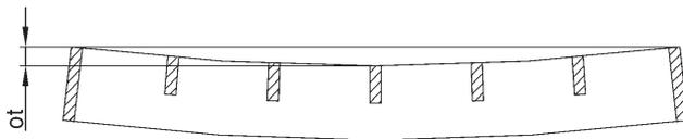
Abweichung für konkav  $o_t$  max. =  $\frac{1}{200}$  der Länge bei Abmessungen > 600 mm: max. 8 mm; kleinere Abmessungen als 600 mm: max. 3 mm
